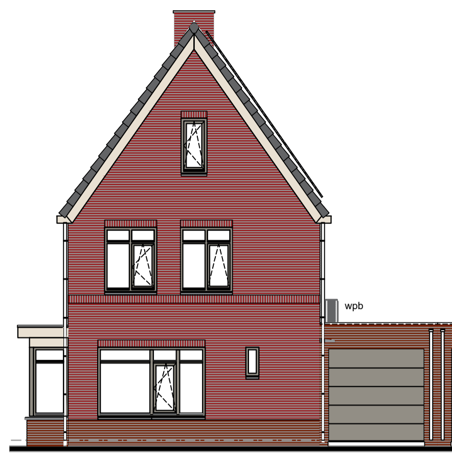
Voorgevel Kavel V36 schaal: 1:100 Plan = 21.000m + NAP
